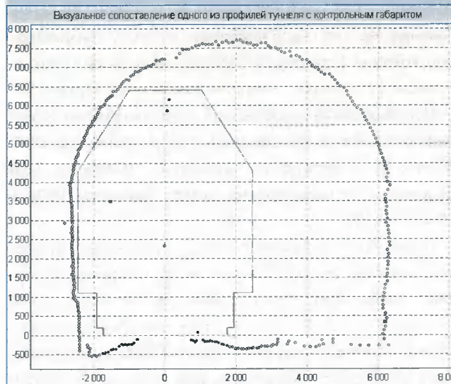
Рис. 6б. Одно из сечений туннеля
